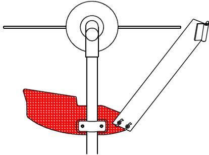
メインパイプと防護板との間に滑り止めシリコンゴムシートを巻いて取り付けて下さい。
